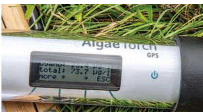
Abb. 5: Display des Chlorophyllmessgeräts Algae Torch. Gesamtchlorophyllgehalt und Chlorophyllgehalt der Cyanophyceen werden in Echtzeit angezeigt.
